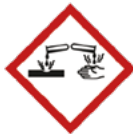
Danger de corrosion
