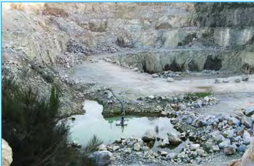
Figure 128 Bassin de fond de fosse isolé
