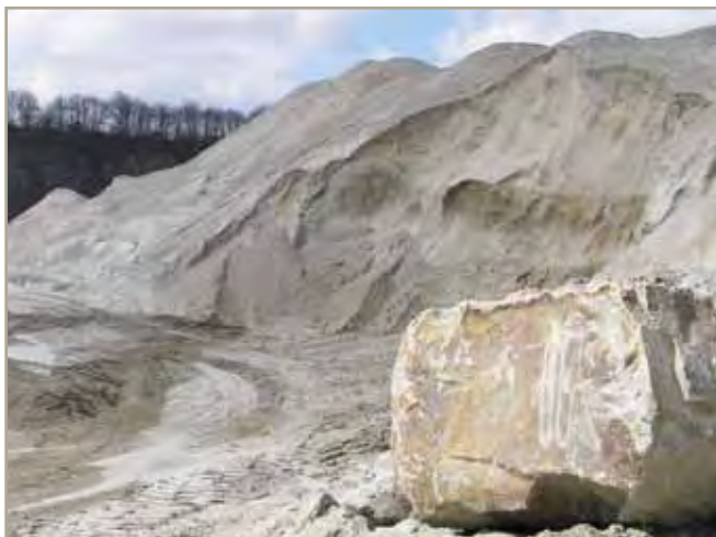
Sables (produits fatals) stockés sur une carrière de granite du Finistère (vue ci-dessus) et mis en remblais sur des fronts d'une carrière de granite de Côte-d'Or (vue ci-contre).
