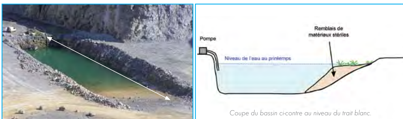
Figure 129 Aménagement d'une zone humide sur bassin de fond de fosse
